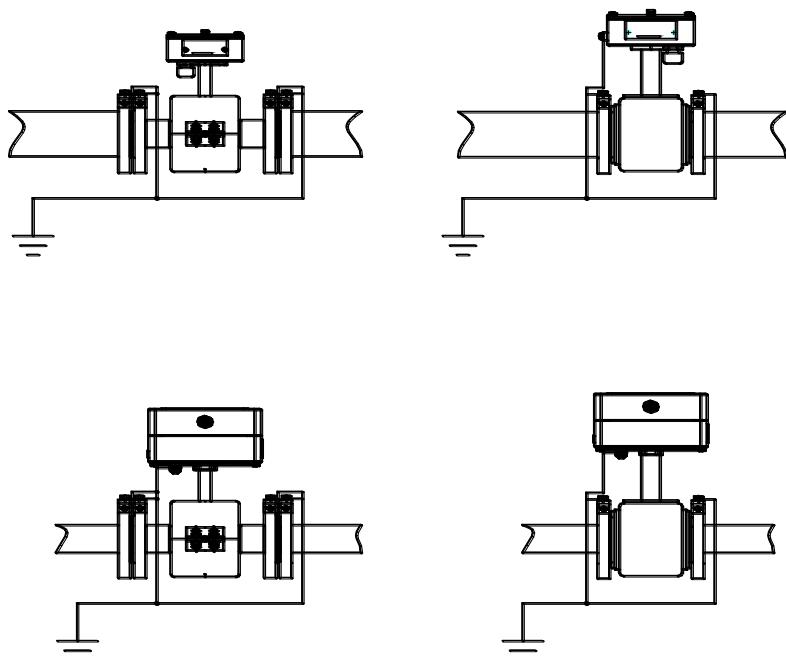
Рисунок 6.6 Заземление расходомера
