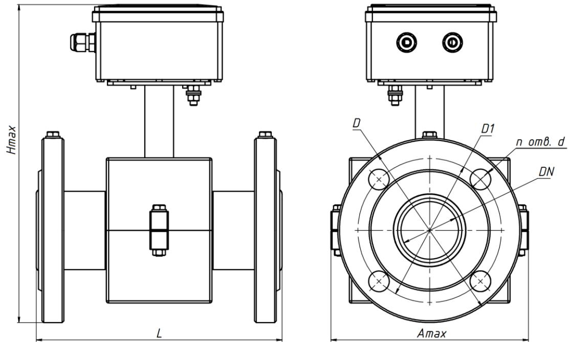
Рисунок Б.5 Габаритные и установочные размеры ПРП
